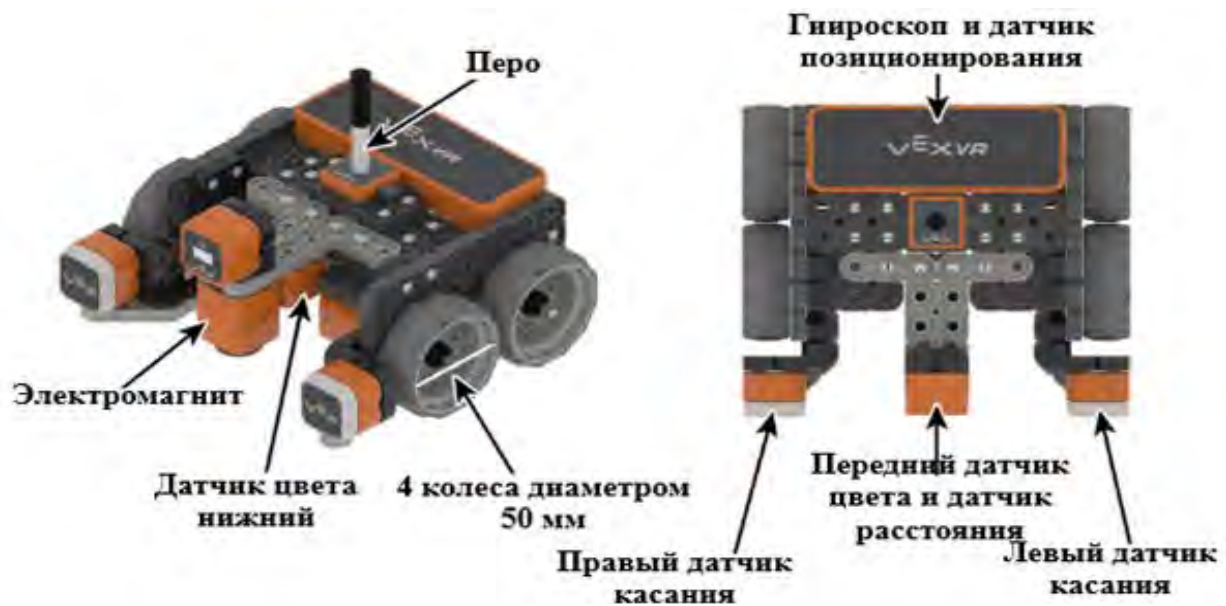
Рис. 7. Конфигурация датчиков робота
